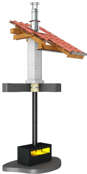
Eksempel på sjakt i overliggende etasje
